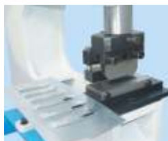
Kit para confeccionar aletas de ventilação Espessura máxima 1,5mm
