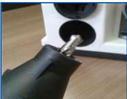
Broca HSS montada no mandril de fixação
